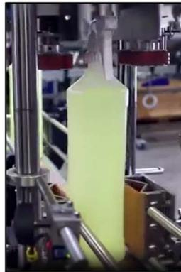
*Figura 3. Tapadora-enroscadora automática VS 500*
