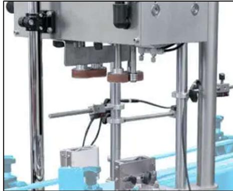
*Figura 2. Tapadora-enroscadora automática VS 500*
