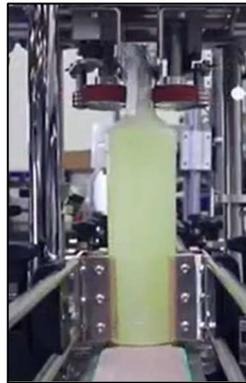
Figura 6. Tapadora-enroscadora automática VS 500
