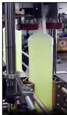
*Figura 4. Tapadora-enroscadora automática VS 500*
