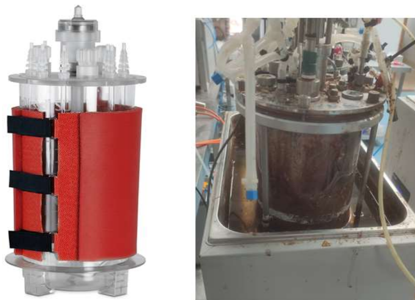
Figura 4: Configuración de un biorreactor con manta calefactora (izquierda) y baño termostático (derecha)
