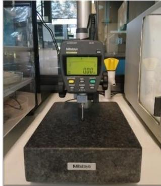
Figura 7. Micrómetro digital (ID-F125, Mitutoyo Corp., Tokio, Japón)
