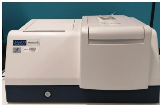
Figura 8. Espectrofotómetro utilizado para la medida de opacidad de los films (UH5300, Hitachi, Japón).
