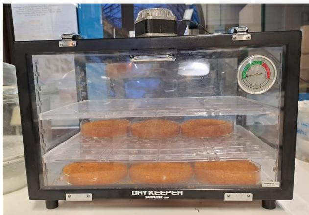
Figura 9. Cabina Sanplatec utilizada para el ensayo de permeabilidad al vapor de agua.
