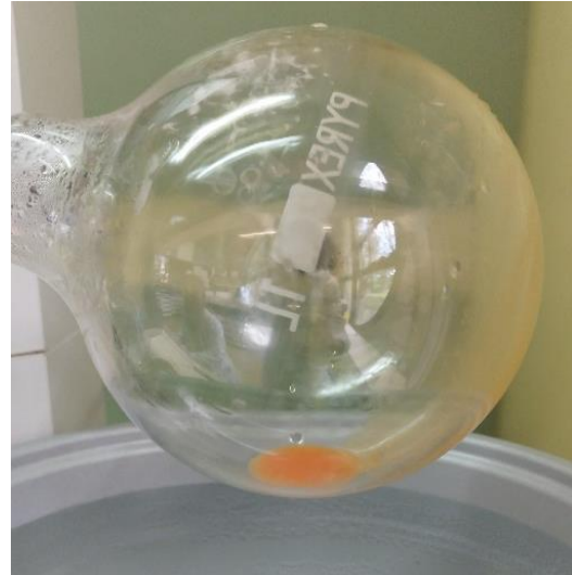
Figura 12. Extracto concentrado en el rotavapor.
