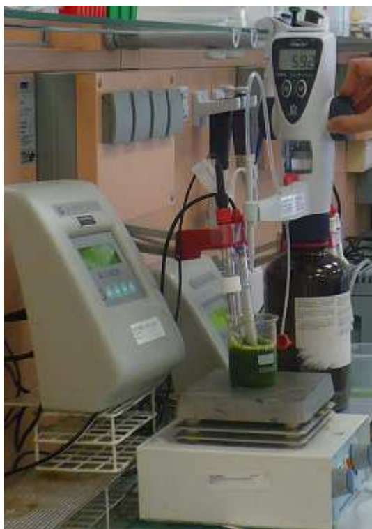
Figura 7: Valoración de acidez en 50ml de zumo filtrado de pimiento.
