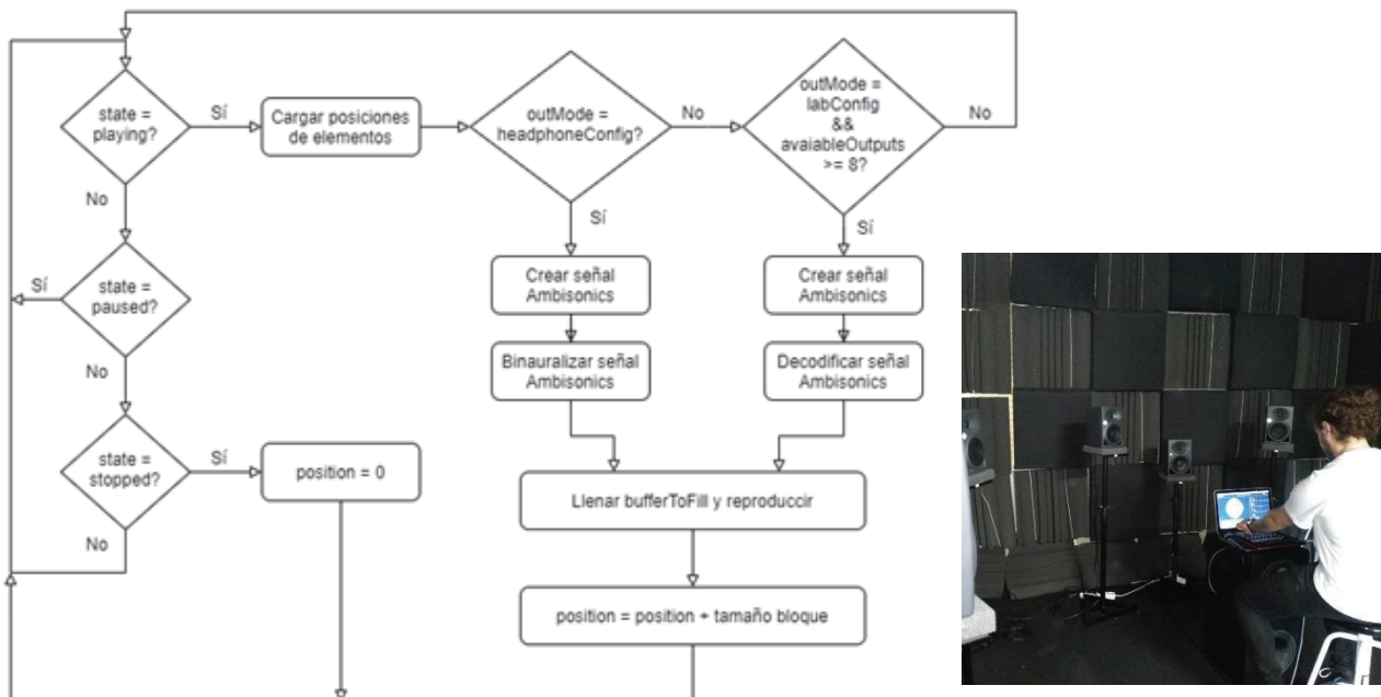
Figura 2 – Flujo de reproducción de la herramienta y ejemplo de presentación mediante configuración de 8 altavoces en la sala para la renderización de audio espacial del Laboratorio de Acústica de la Universidad Pública de Navarra.
