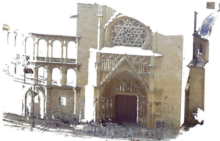
Figura 1 – Escaneado 3D de la Puerta de los Apóstoles
