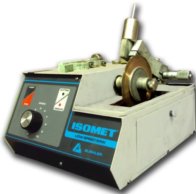
Figura II.II: Imagen de la sierra “Buehler isomet low speed saw” refrigerada por agua utilizada en la preparación de las muestras.
