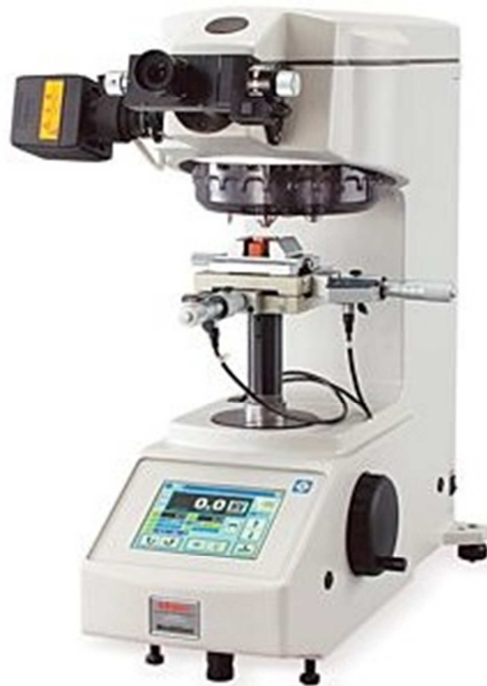
Figura II.XII: Imagen del microdurómetro “Mitutoyo microwizhard” utilizado en el estudio de la caracterización de las propiedades mecánicas del material.
