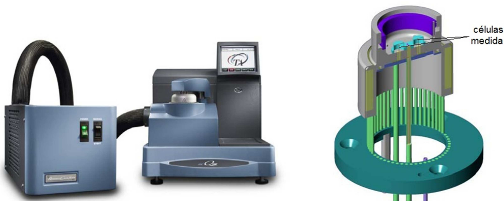
Figura II.VII: Dispositivo DSC TAQ100 utilizado en la caracterización de la aleación, acompañado de una representación de la celda donde se realiza el análisis de las muestras.
