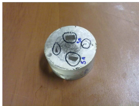
Figura II.III: Imagen del encapsulamiento para realizar los ensayos de microdureza (izda.) y del encapsulamiento ya metalizado para realizar los microanálisis en el SAI (dcha.).
