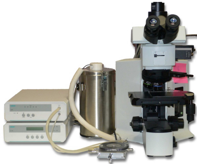
Figura II.VI: Imagen del microscopio óptico, de la pletina Linkam THMS600 y los dispositivos CI94 y LNP utilizados para el estudio y la optimización de la microestructura del material.
