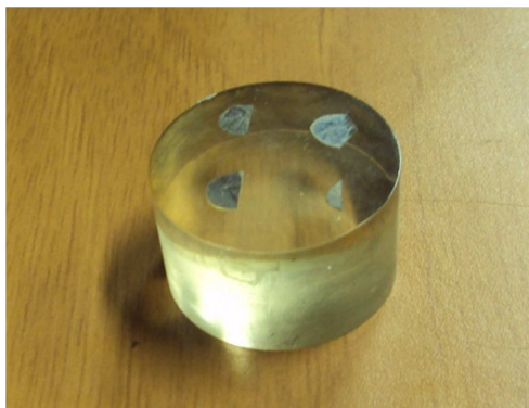
Figura II.III: Imagen del encapsulamiento para realizar los ensayos de microdureza (izda.) y del encapsulamiento ya metalizado para realizar los microanálisis en el SAI (dcha.).
