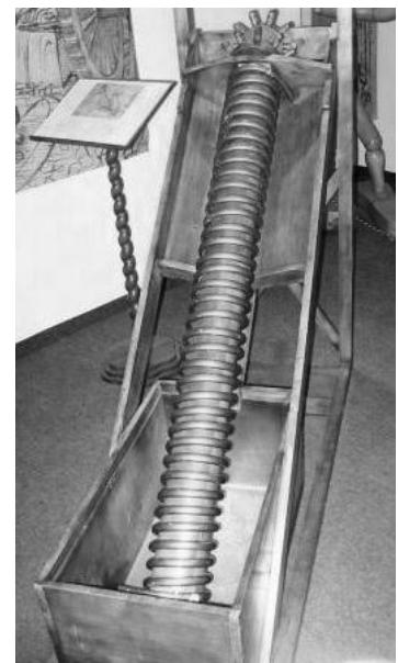
Fig. 4: Cilindro espiral para subir agua ideado por da Vinci.
