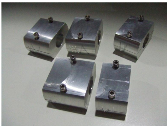
Fig. 7: Placas desmontables. Todas tienen un número grabado por una cara (que debe quedar en la parte superior) y tantas muescas en un lateral como indique el número (que deben quedar mirando hacia el operario).
