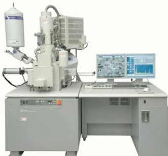
Figura 2.10: Imagen del microscopio electrónico de barrido JSM-5610LV del Servicio de Apoyo a la Investigación utilizado para la caracterización microestructural de la aleación.
