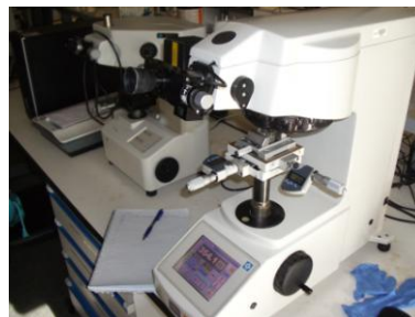
Figura 2.9: Durómetro con sus dos manillas de posicionamiento, otra de enfoque y un único objetivo.
