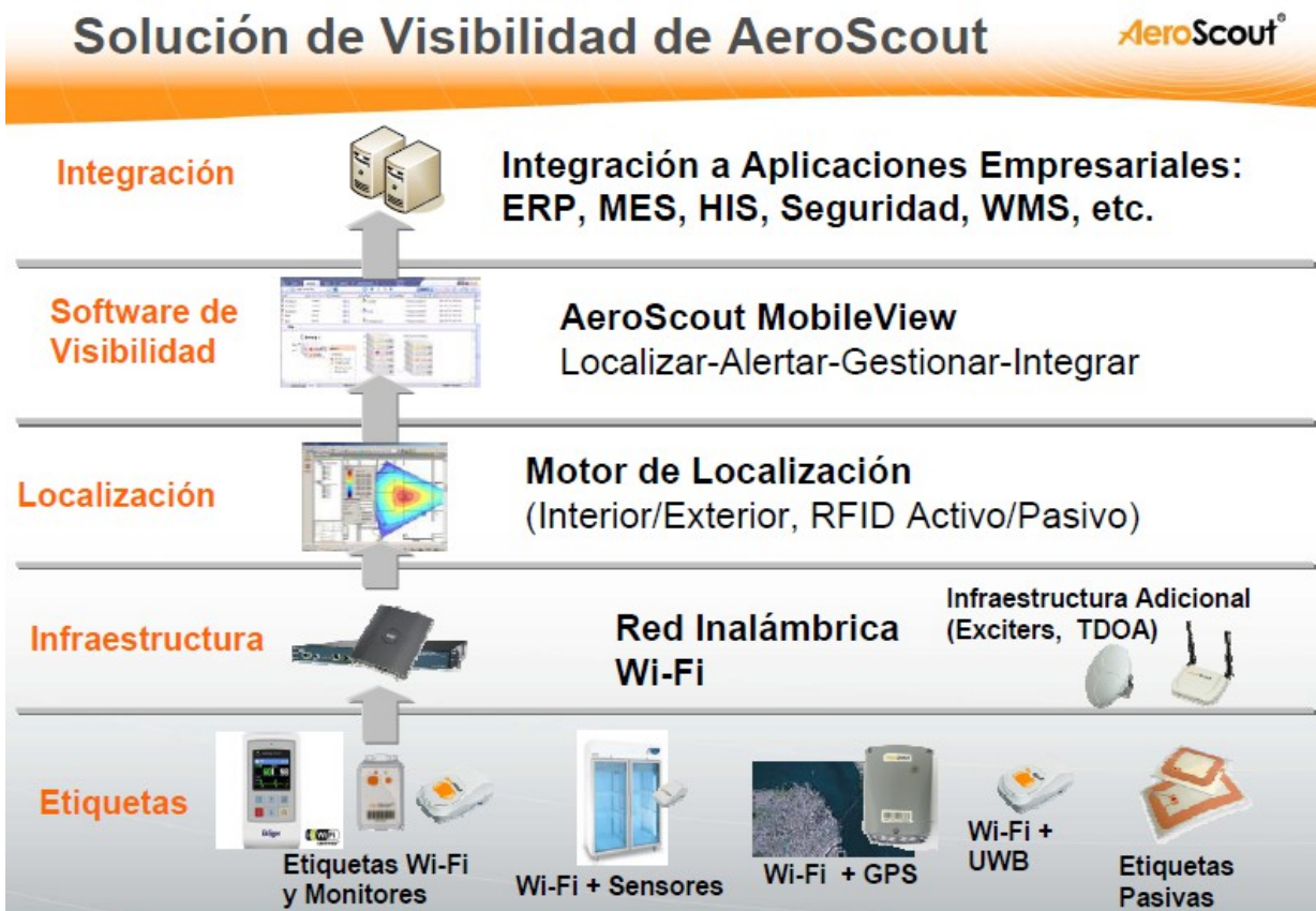
Figura 3.26: Solución de control y localización de AeroScout® [12]
