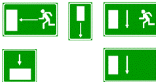
Vía/salida de socorro
