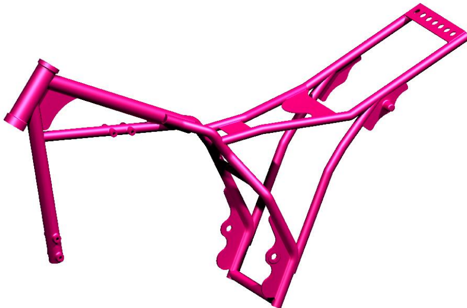
Figura 77. Chasis modelizado de Yamaha SR250
