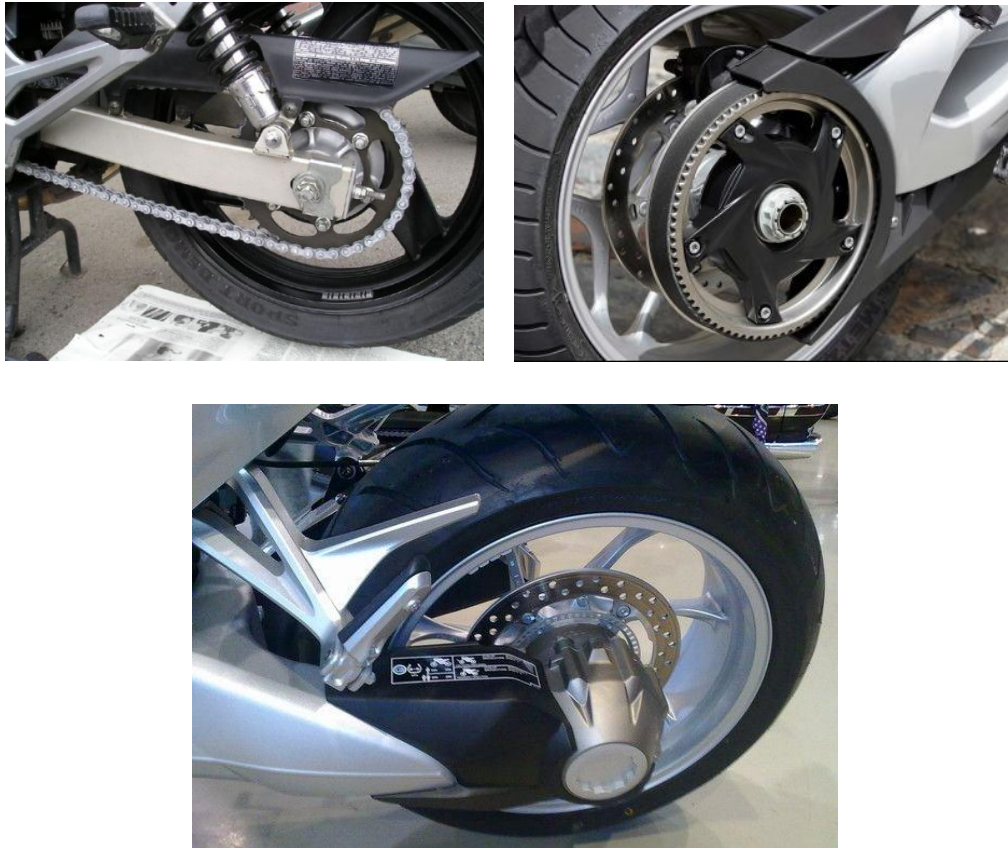
Figura 36. Transmisión secundaria por cadena, correa y cardan
