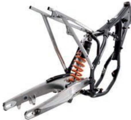
Figura 42. Chasis Simple Cuna Desdoblado, KTM 250X (2011)
