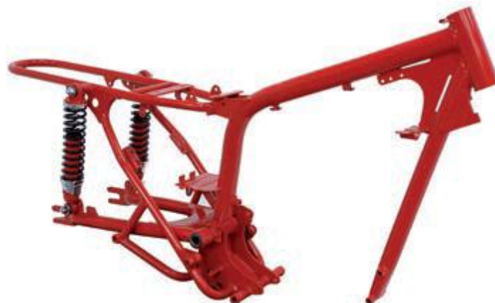
Figura 41. Chasis Simple Cuna Abierto, Ducati 24 horas (1973)
