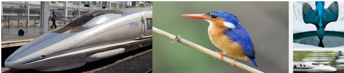
Figura 10. Comparación del martín pescador con el frontal del tren Shinkansen
