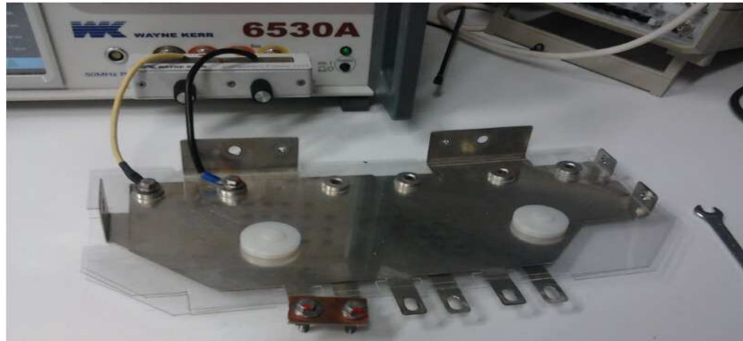
Fig. 15: Montaje para el cálculo de inductancia del busbar de Airbus.
