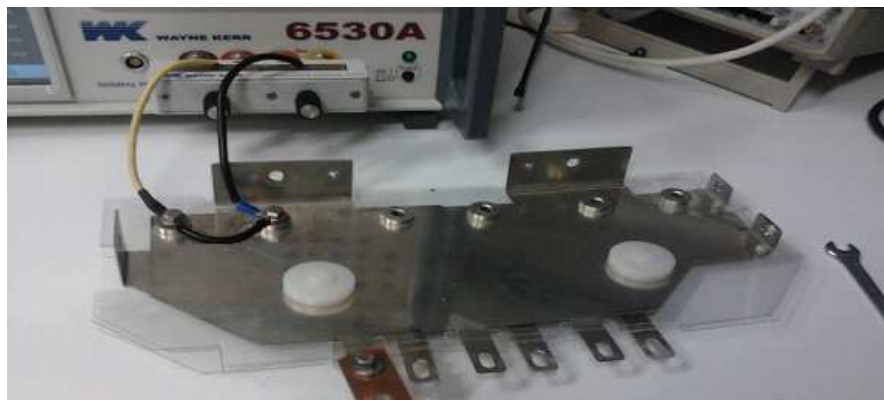
Fig. 16: Montaje para el cálculo de la inductancia de los cables.
