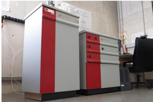
Figura 25: Magnetómetro SQUID.
