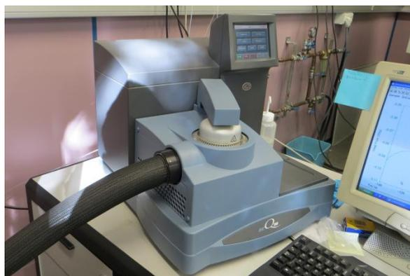
Figura 23: Calorímetro diferencial de barrido TAQ 100.
